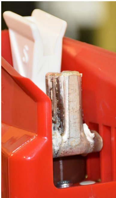
Fotografia 3 a 8: Detalhe dos contatos do seccionador após as aplicações de corrente no circuito principal e operações manuais.
