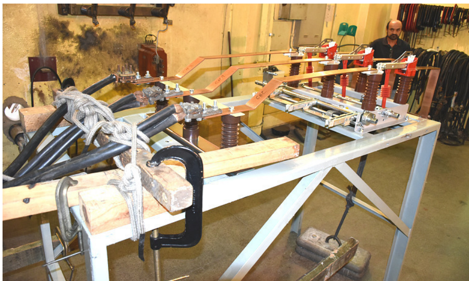
Fotografia 1: Vista geral da montagem antes das aplicações de corrente no circuito principal.
