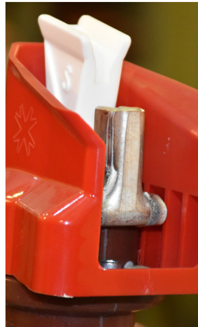
Fotografia 3 a 8: Detalhe dos contatos do seccionador após as aplicações de corrente no circuito principal e operações manuais.
