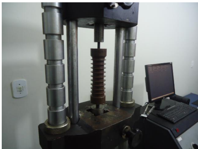
Montagem para ensaio de tração
